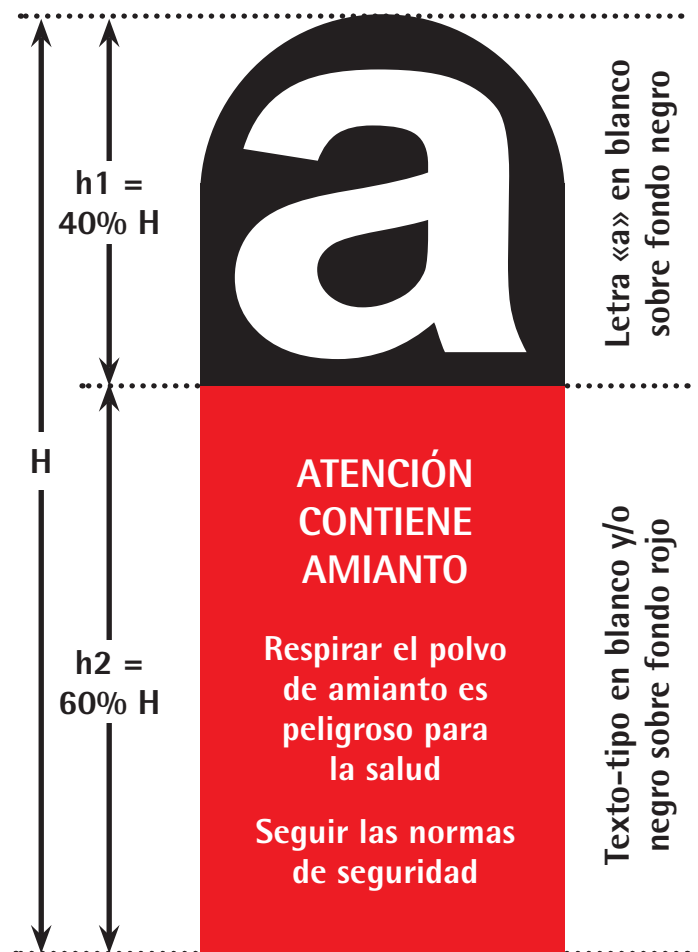
Figura 2. Etiquetado de productos con amianto.
